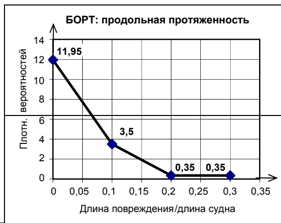
Рис. 3. Повреждение борта: продольная протяженность
