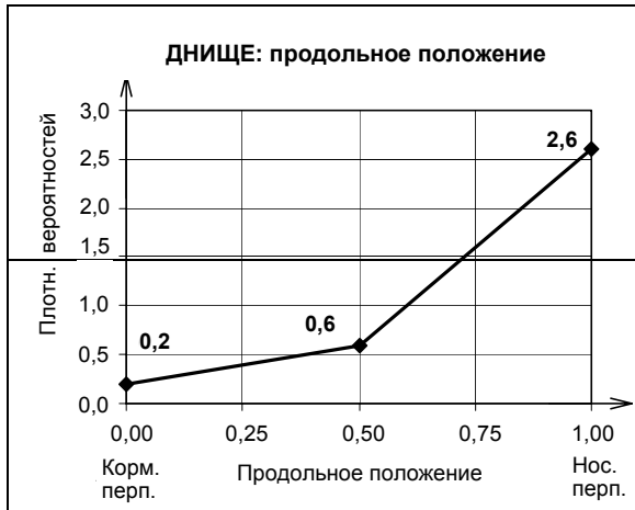
Рис. 7. Повреждение днища: продольное положение
