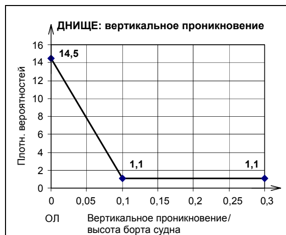
Рис. 11. Повреждение днища: вертикальное проникновение
