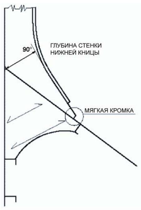
Рис. 3. Определение глубины полки нижней кницы
